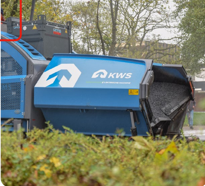
Figuur 6 Een elektrische asfaltspreidmachine, een voorbeeld van een non-road machine.
