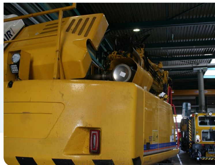
Figuur 11 Kraan voorzien van een overdrukcabine, de filterunit is links op de foto zichtbaar
